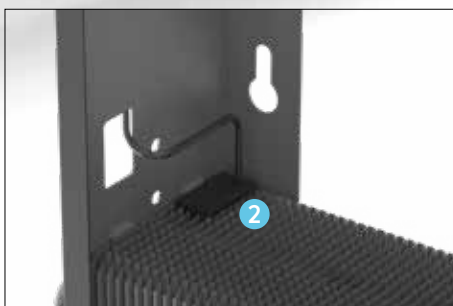
2 Klik de watertemperatuursensor op de warmtewisselaar.
